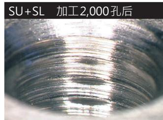
进刀处表面粗糙度 Ra=1.1μm
